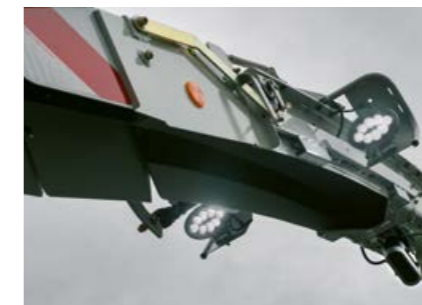
LED munkalámpa: A LED High End munkalámpa csomaggal a kifúvótorony is LED lámpával van felszerelve. Ezzel még éjjel is kiválóak a látási viszonyok.
