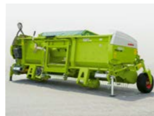
PICK UP 380 lengőkerettel és kiegészítő acélgörgőkkel az ideális talajkövetésért
