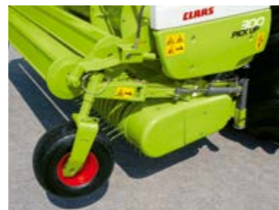
Hidraulikusan behajtható támkerekek
